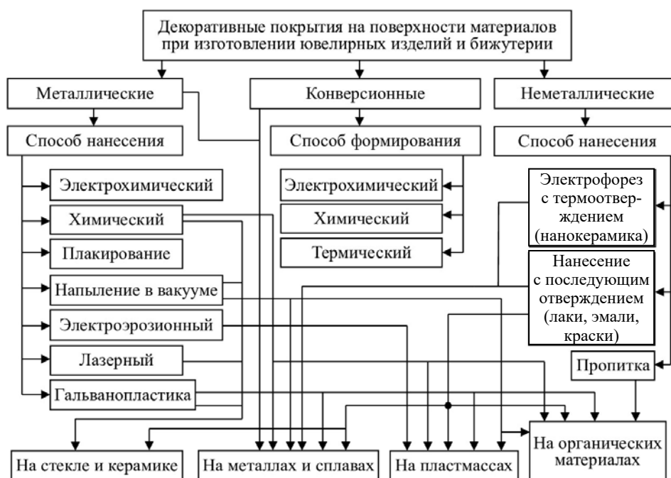
Рис. 1. Схема использования декоративных покрытий на поверхности основных групп материалов, применяемых при изготовлении ювелирных изделий и бижутерии
