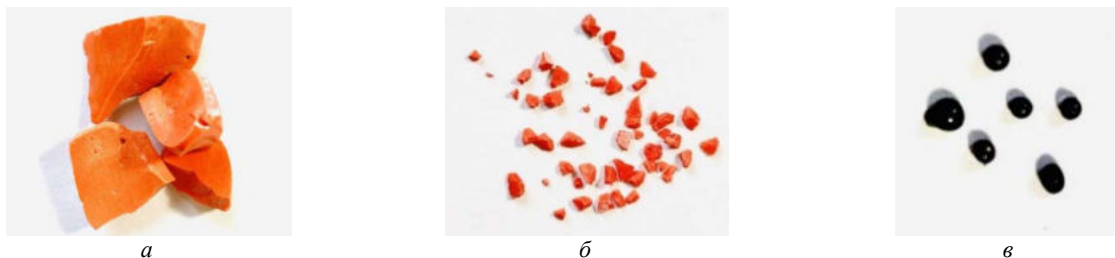
Рис. 4. Этапы изготовления эмалевой зерни с помощью пламени газовой горелки: а – кусковая эмаль непрозрачная красная № 135; б – размельченная эмаль; в – зернь с пригарной пленкой при обработке пламенем газовой горелки
