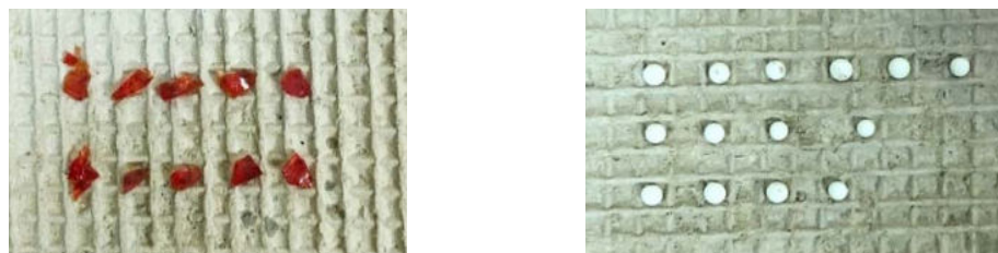
Рис. 6. Получение зерни на ячеистом асбестовом картоне
