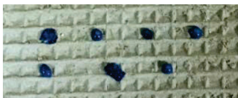
Рис. 16. Формирование зерни из кусочков эмали неудачной формы
