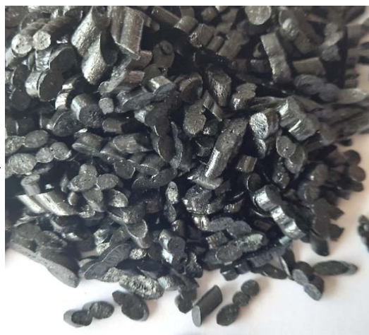
Рис. 3. Отходы ППУ после измельчения (а) и гранулят из отходов ППУ (б)
