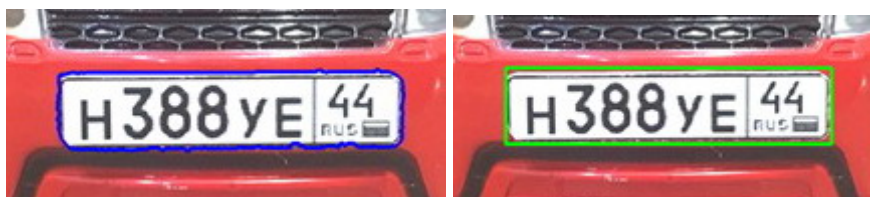
Рис. 2. Выделение контура с автомобильным номером детектором границ Канни (до и после аппроксимации)
