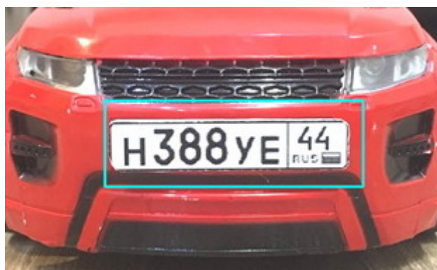
Рис. 3. Выделение контура с автомобильным номером с помощью метода Виолы – Джонса
