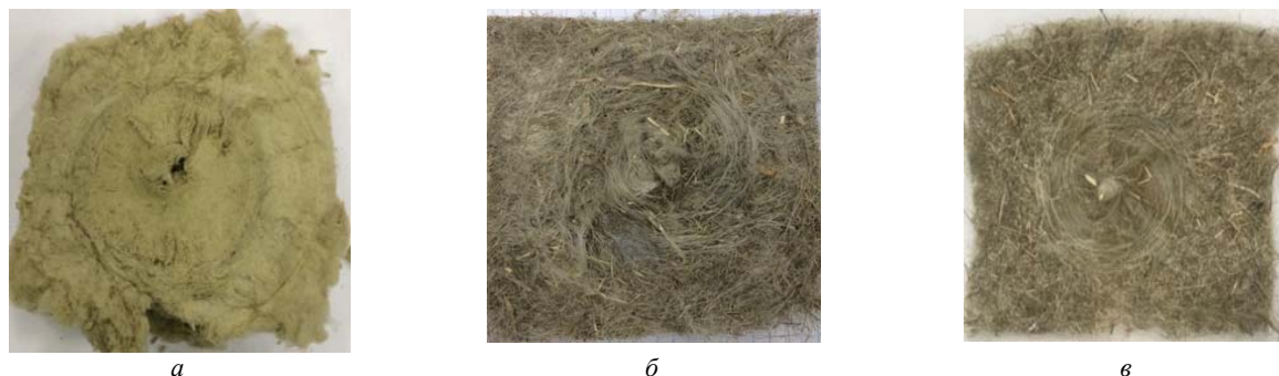
Рис. 2. Образцы строительных утеплителей после испытания на стойкость к истиранию:
