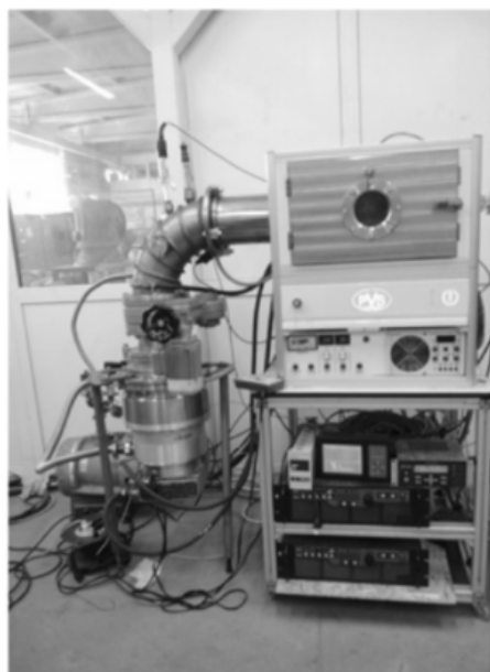
Рис. 1. Модульная плазменная установка для нанесения тонких металлических покрытий
