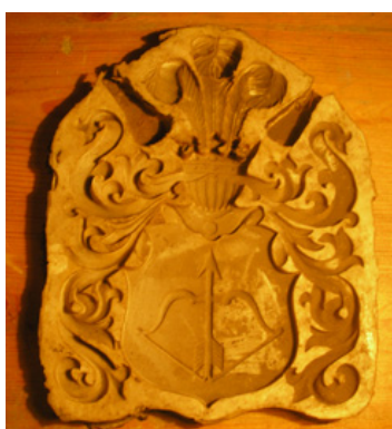
Рис. 3. Форма «герба» для «негативного» наращивания гальванопластических слоев металла (фото из открытых источников)
