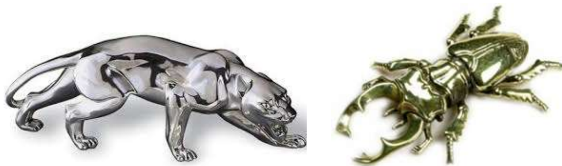
Рис. 5. Гальванопластические объемные изделия при «положительном» наращивании металла при обеспечении высокой отражающей способности поверхности металла (фото из открытых источников)
