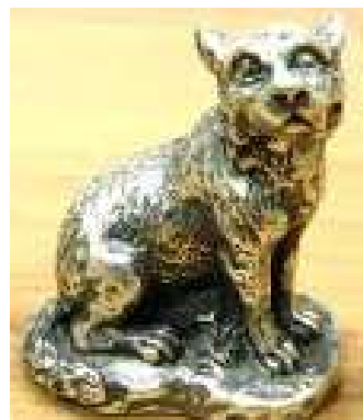
Рис. 4. Пример гальванопластического изделия с высокой шероховатостью поверхности из-за недостатков технологии формирования слоев металла (фото из открытых источников)
