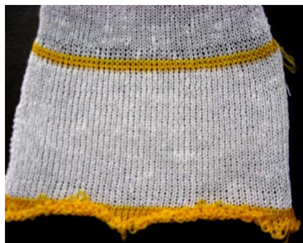
Рис. 4. Образец трикотажного полотна, полученный из вьюрковой пряжи
